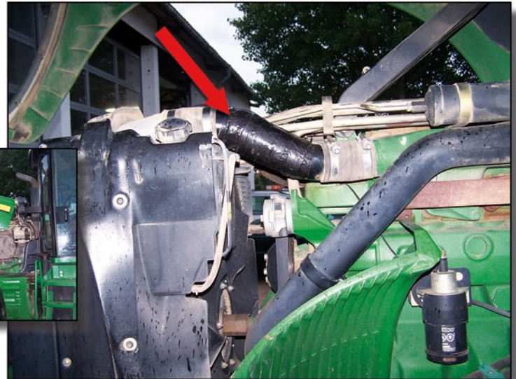
Příklad umístění cívky na trubce plnicího vzduchu John Deere 8420
