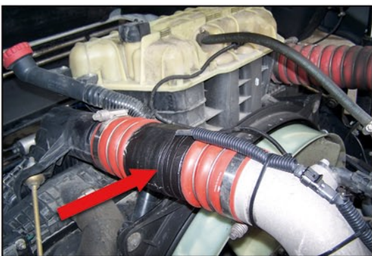
Připravená hadice plnicího vzduchu, která byla vybavena cívkovým systémem, nahrazuje číslo dílu MAN 81.96.301.0900
