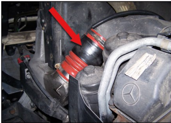
Připravená hadice plnicího vzduchu, která byla vybavena cívkovým systémem, nahrazuje číslo dílu MB A 003 094 08 82
