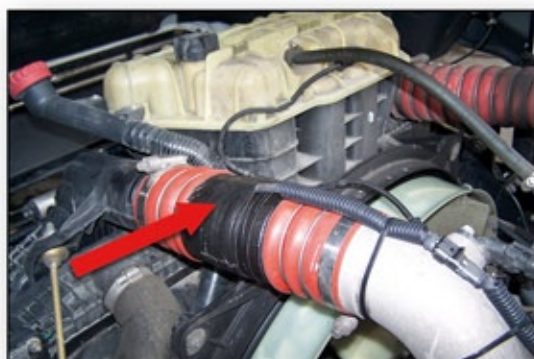
Vorgefertigter Ladeluftschlauch, der mit einem Spulensystem konfektioniert wurde, ersetzt MAN-Teilenummer 81.96.301.0900.
