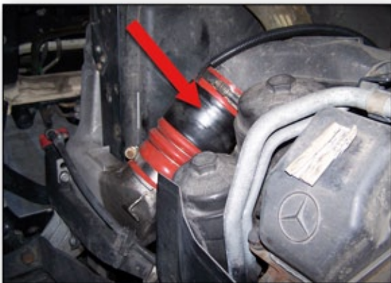
Vorgefertigter Ladeluftschlauch, der mit einem Spulensystem konfektioniert wurde, ersetzt MB Teilenummer A 003 094 08 82.
