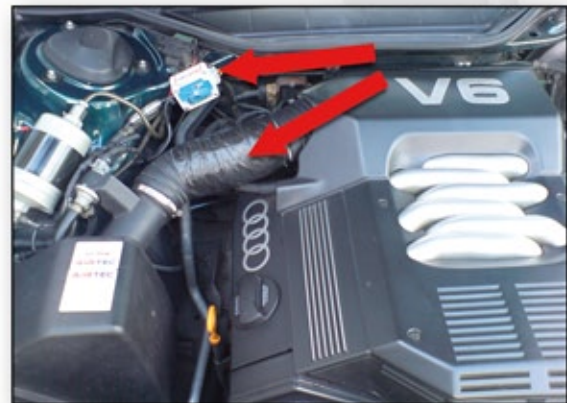
Einbaubeispiel in einem Audi A6. Air-Tec Gerät und Spule auf dem Ansaugschlauch.
