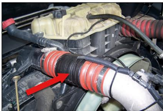
esempio su un MAN di un tubo dell'aria predisposto per l'installazione del sistema.
