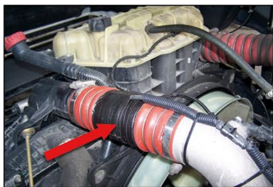
Gatava pūtes gaisa šļūtene, kas tiek izgatavota ar spoles sistēmu, aizstāj MAN detaļu ar numuru 81.96.301.0900
