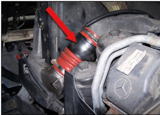
Gatava pūtes gaisa šļūtene, kas tiek izgatavota ar spoles sistēmu, aizstāj MB detaļu ar numuru A 003 094 08 82
