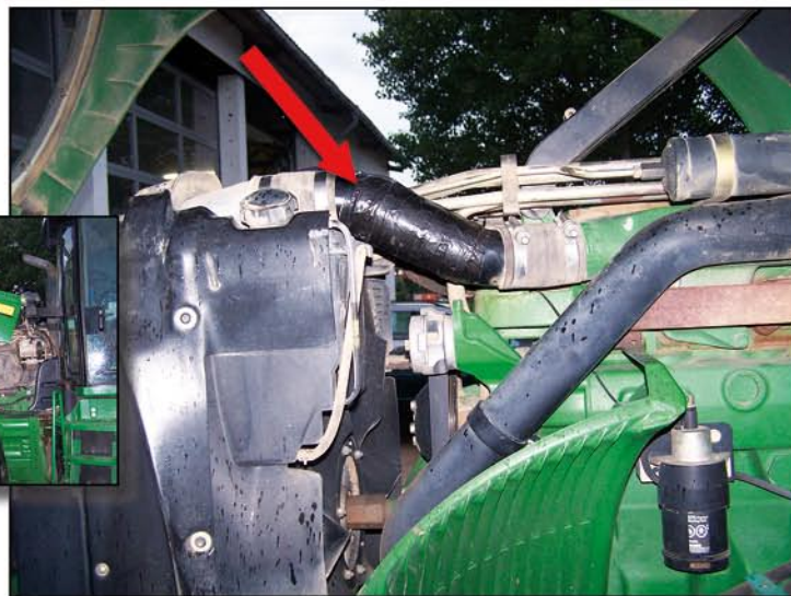
Piemērs: spoles konstrukcija uz John Deere 8420 pūtes gaisa caurules
