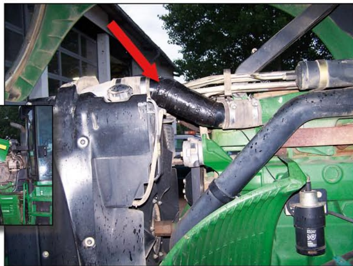
Voorbeeld van spoelenopbouw op luchtinlaatpijp John Deere 8420
