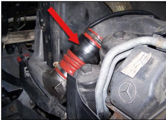
Geprepareerde inlaatluchtslang die van een spoelen-systeem is voorzien; vervangt MB onderdeelnummer A 003 094 08 82
