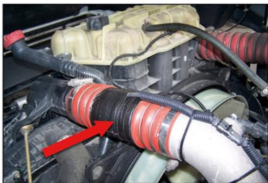
Geprepareerde inlaatluchtslang die van een spoelen-systeem is voorzien; vervangt MAN onderdeelnummer 81.96.301.0900
