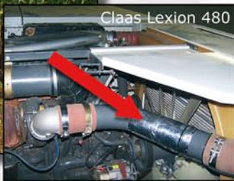
Voorbeeld van een spoelwikkeling op de luchtinlaat
