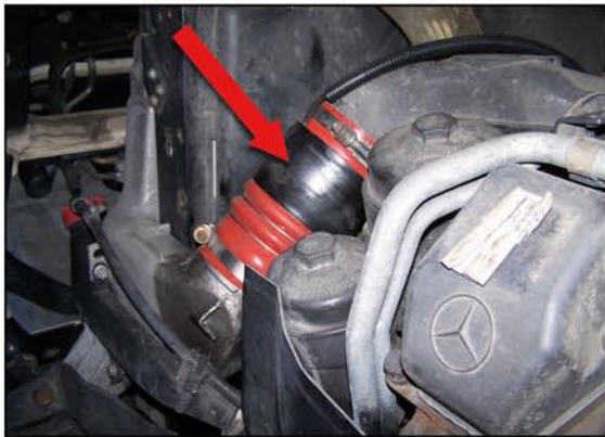
Сборный воздуходувной шланг, изготовленный с системой катушки, заменяет у MB деталь № A 003 094 08 82
