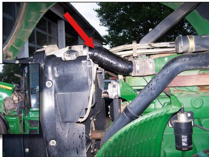
Пример оборудования катушкой в воздуходувной трубе трактора John Deere 8420
