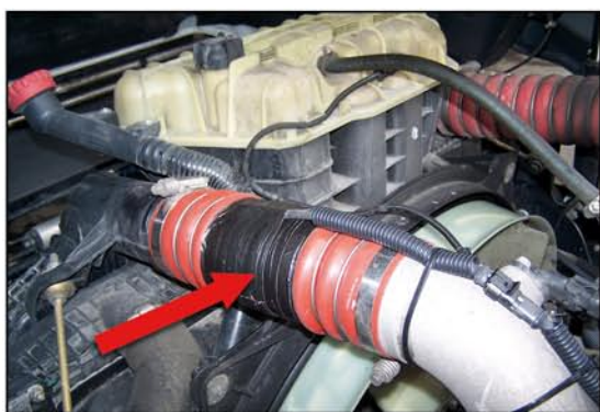
Сборный воздуходувной шланг, изготовленный с системой катушки, заменяет у MAN деталь № 81.96.301.0900
