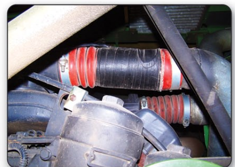
Neu entwickelter Ladeluftschlauch mit Spulensystem für Krone Big X V8 650
