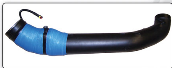
Mit einer Erregerspule modifiziertes Ansaugrohr Volvo FH 440
