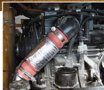
Die Erregerspule des Air-Tec-Systems wird am Ladeluftschlauch montiert.
