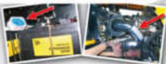
Einbau des Air-Tec-Gerätes im Batteriekasten
