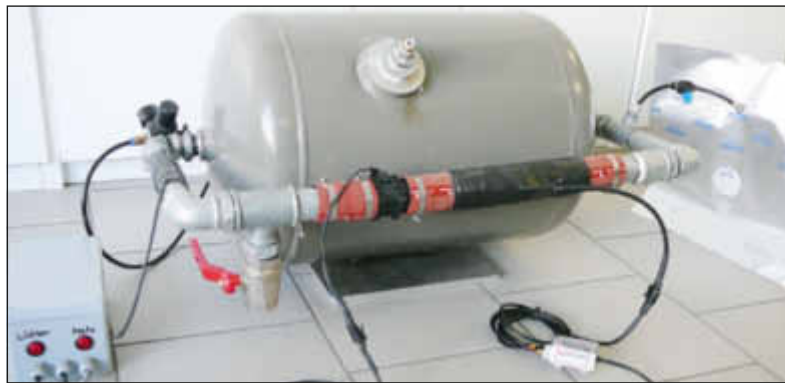
Versuchsanordnung: Die Ringleitung ist mit einem Gummischlauch mit Erregerspule sowie einem Gas-Probenbeutel versehen.
