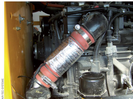
Aufbau einer Erregerspule auf dem Ladeluftschlauch bei einem JCB-Radlader.
